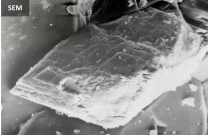
Plagioclase by SEM (LAMINAE over LAMINAE)
