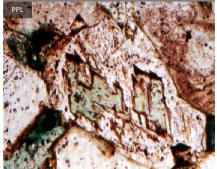
فيلدسبار حدث له internal dissolution واللون الاخضر هو صبغة حتى نتعرف على ال pore spaces
